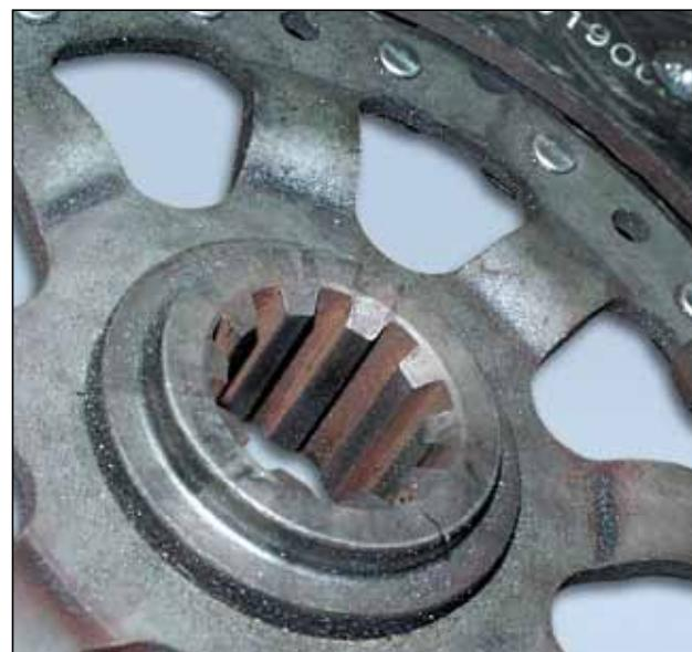
**15. Jednostrana istrošenost uzubljenog profila glavčine lamele (pojava oštih vrhova)****Uzrok:**
