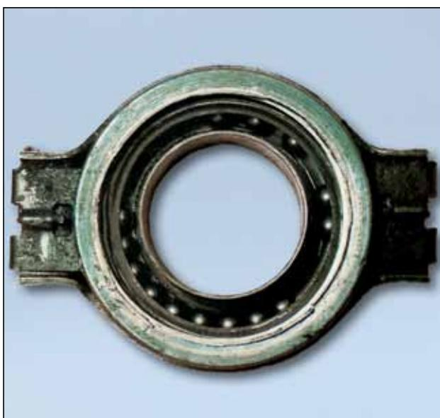
**9. Kućište potisnog ležaja i kuglični ležaj oštećeni****Uzrok:**
