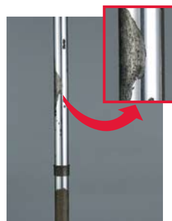
Oštećenje na jednoj strani površine klipnjače kao na slici
