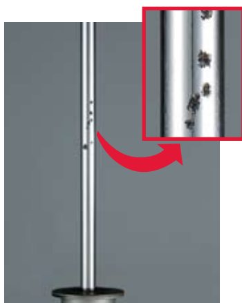
Oštećen kromirani premaz klipnjače
