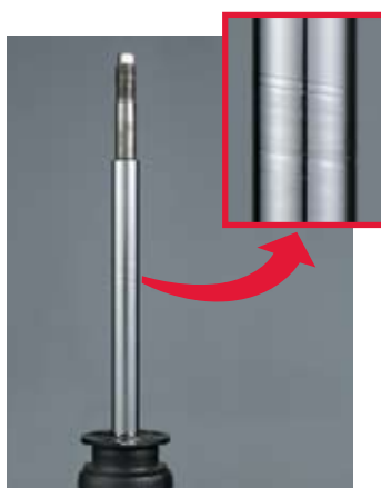
Oštećena površina klipnjače kao na slici
